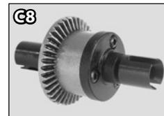
23. Placez l'autre couvercle de différentiel sur le bloc différentiel en vérifiant que les trois trous de vis de différentiel sont bien alignés et le joint torique est bien en place. Fixez le bloc différentiel avec les trois vis à tête ronde de 2x14mm (C8).
