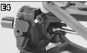
33. Faites glisser la moitié droite de la cloison sur le différentiel. Insérez l'arbre d'entraînement droit dans la cuvette de différentiel et rejoindez les deux moitiés de cloison (E5). **Note :** En joignant les deux moitiés de cloison avant, connectez bien (ajustez) le support de renvoi d'angle de direction entre les deux moitiés (E6).
