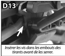
Insérer les vis dans les embouts des tirants avant de les serrer.
