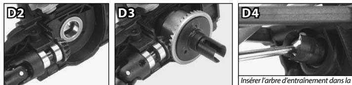
Insérer l'arbre d'entraînement dans la cuvette de différentiel.
