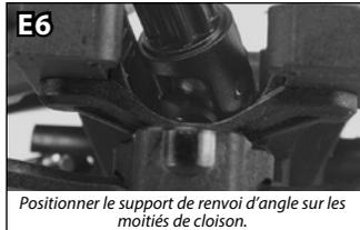
Positionner le support de renvoi d'angle sur les moitiés de cloison.
